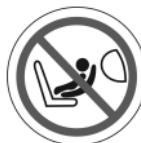
\* Les systèmes de retenue installés en position dos à la route ne peuvent jamais être utilisés sur un siège ayant un airbag frontal activé (fig. 12)!
